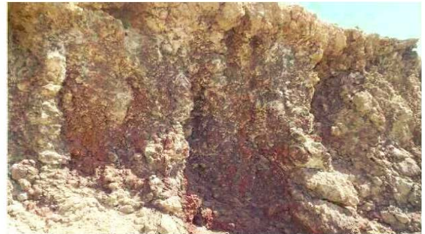
Նկ. 3 Պատվարների կառուցման համար օգտագործվող ավագախիճային խառնուրդի հանման լանջը
